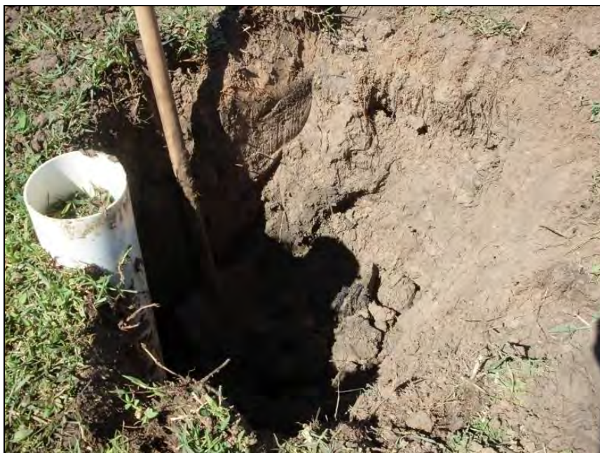
Figura 2 – Trincheira aberta para retirada de depósito tecnogênico.
