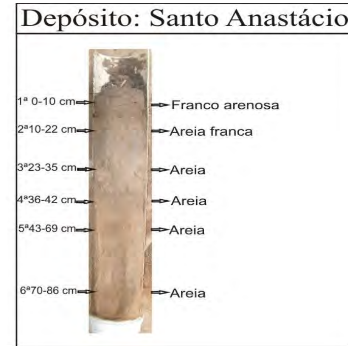
Figura 27 – Representação do depósito tecnogênico coletado no encontro do rio Santo Anastácio com a represa da SABESP
