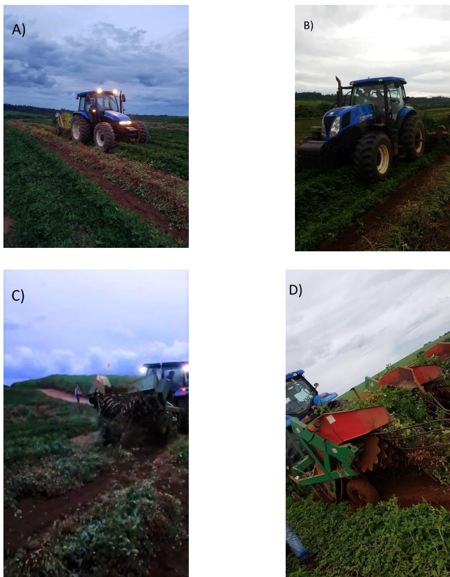
Figura 2. Conjuntos trator-arrancador. A) trator TL 85 New Holland, B) trator New Holland T7.205, c) Arrancador 2x1, D) Arrancador 4x2.
