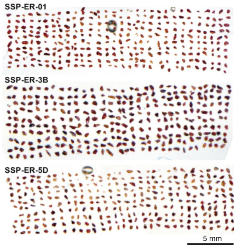
Figura 6 - Fotomicrografia das seções polidas com cristais de rutilo das amostras estudadas. Montagem feita em resina epóxi.
