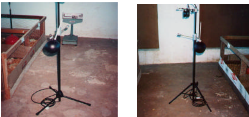
Figura 3. Termômetros de globo negro instalados nos dois ambientes a 0,70 m do piso.
