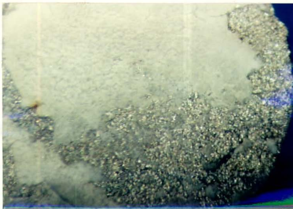
FIGURA 12 - Cilindro de amálgama com V na superfície. (aumento 33x).
