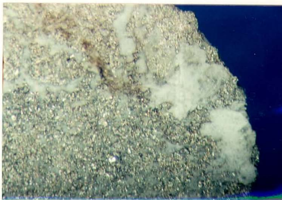
FIGURA 10 - Superfície do cilindro de amálgama, após cisalhamento, com V (Aumento 33x)
