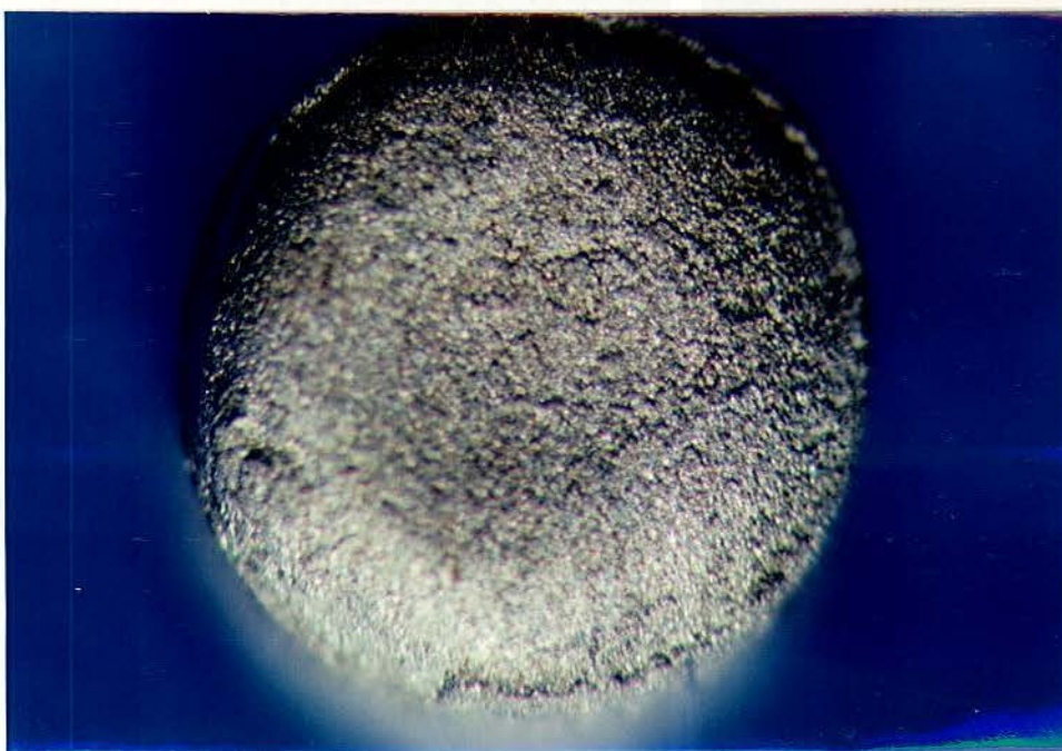
FIGURA 6 - Superfície do cilindro de amálgama após o seu cisalhamento, quando foi utilizado o SMP (aumento 21x)
