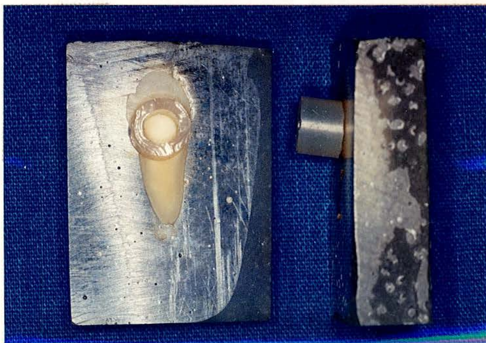
FIGURA 2 - Matriz de polietileno fixada à superfície dentinária
