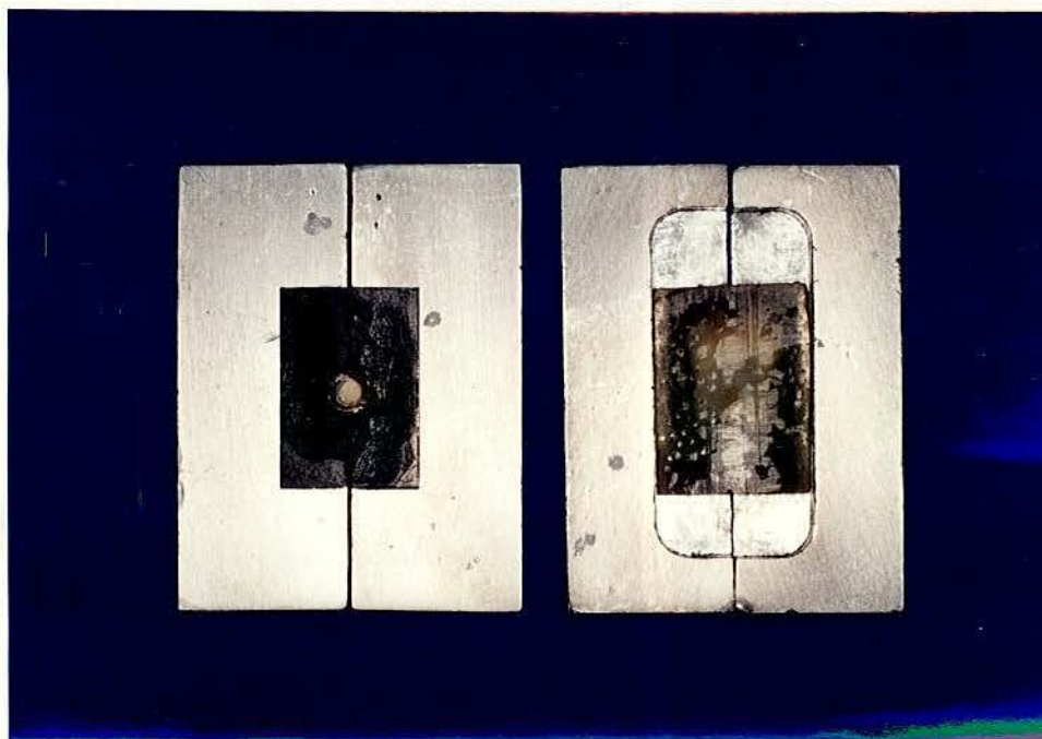
FIGURA 3 - Matriz bipartida de alumínio/teflon para fixação do conjunto bloco de resina acrílica/tubo de polietileno
