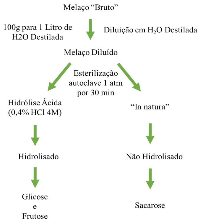
Figura 13: Esquema do preparo da solução de melaço “in natura” e hidrolisado utilizado no cultivo mixotrófico.
