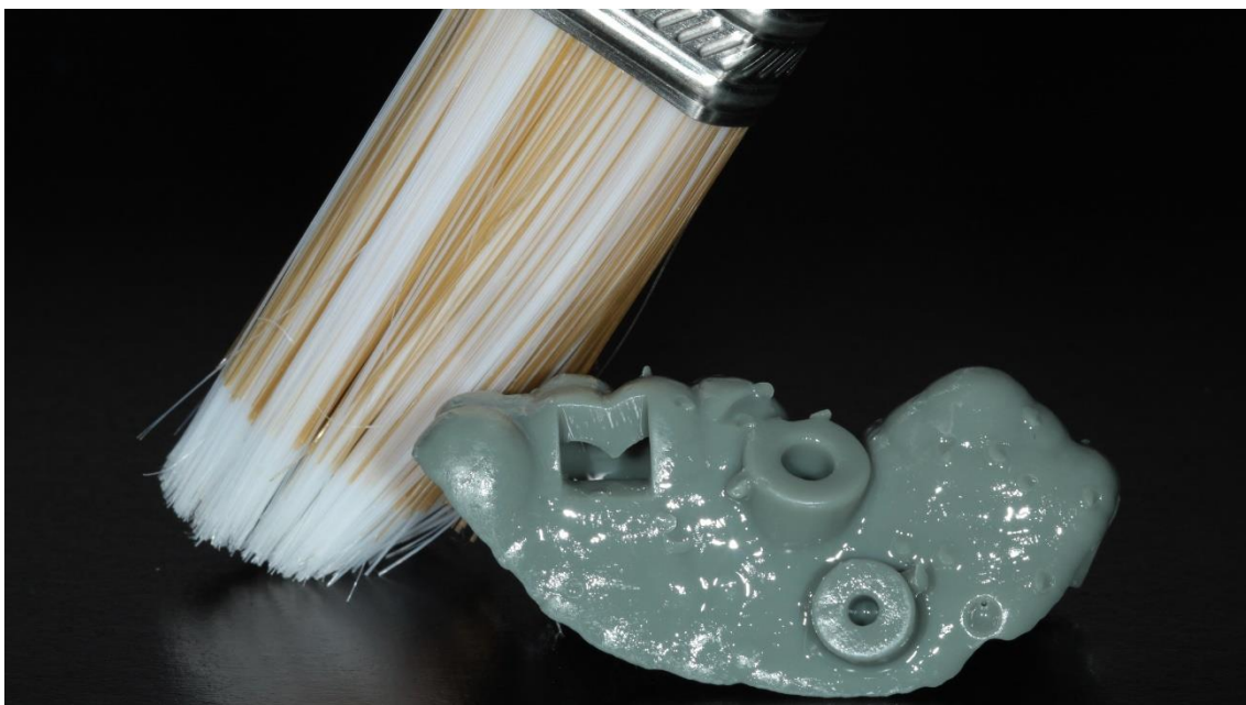
Figura 9 - Utilização do pincel para remoção de excessos de resina
