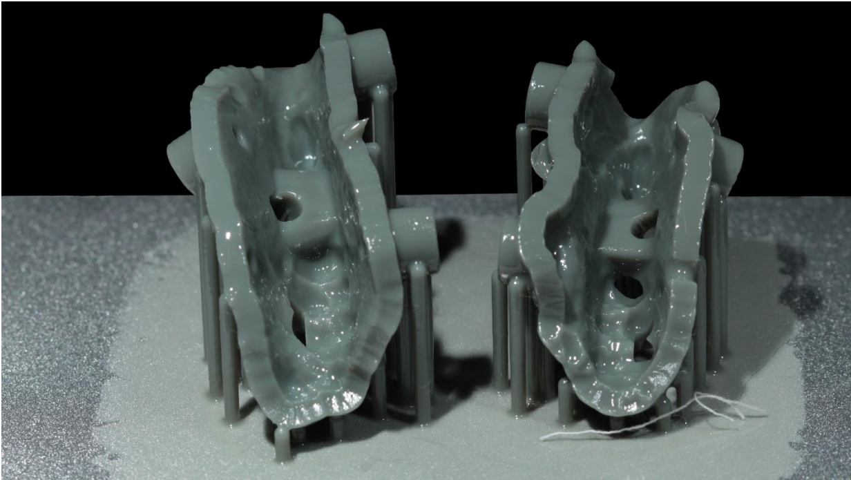
Figura 4 - Guias cirúrgicos unidos na base de resina que está aderida no suporte da impressora
