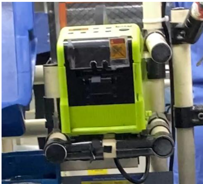
Figura 19 – Suporte da etiquetadora do posto P8 antes da reforma
