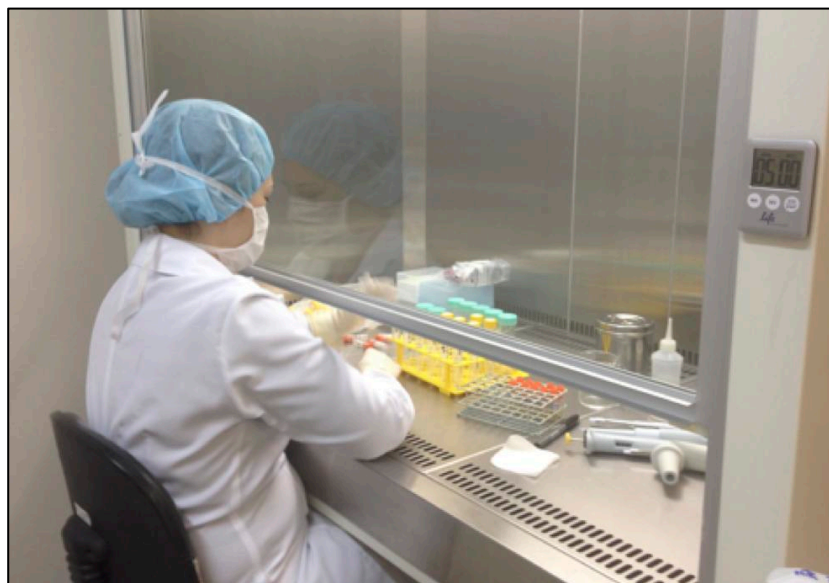
Figura 11: Câmara de fluxo laminar vertical utilizado para a manipulação celular evitando a contaminação.
