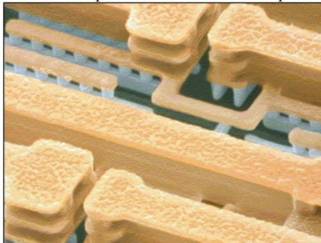
Figura 7: Microscopia de interconectores de um processador
