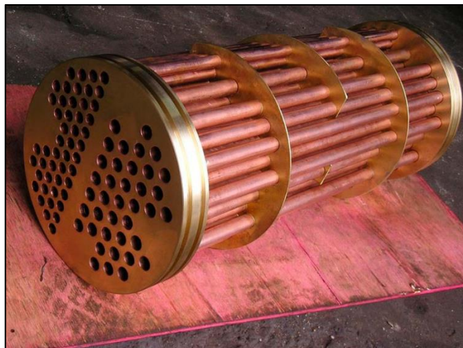
Figura 9: Trocador de Calor Casco Tubo
