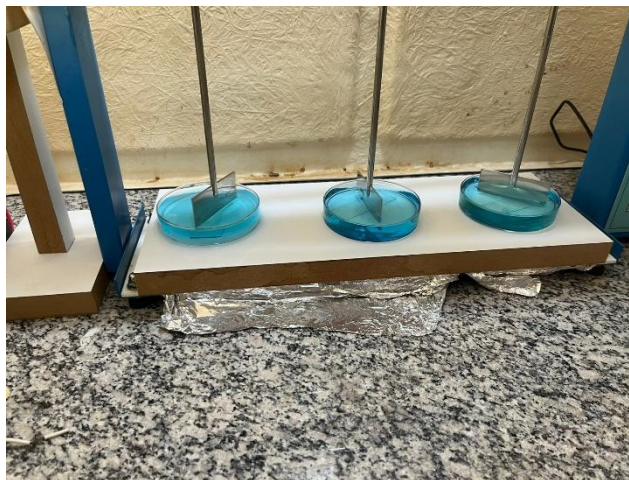
Figura 8 – Sistema de fotocatalise contendo filme fino, vidro relógio e solução de azul de metileno.
