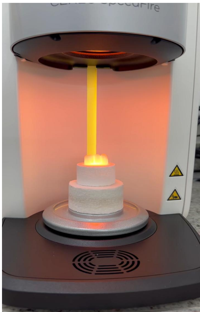
Figura 10 – Sinterização no forno SpeedFire da DentsplySirona.
