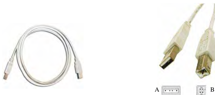
Figura 8. Cabo padrão USB (esquerda) e terminais do cabo (direita), o terminal “A” conecta-se ao computador industrial e o “B” conecta-se no conversor A/D.
