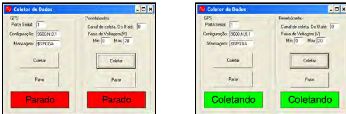
Figura 24. Tela inicial (esquerda), e as informações do GPS e do penetrômetro sendo coletadas simultaneamente (direita).
