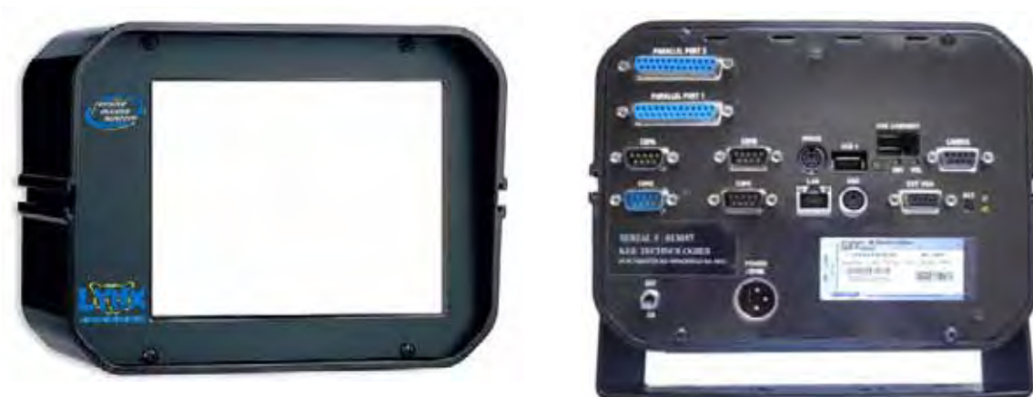
Figura 10. Vista frontal do computador industrial (esquerda) e traseira (direita).
