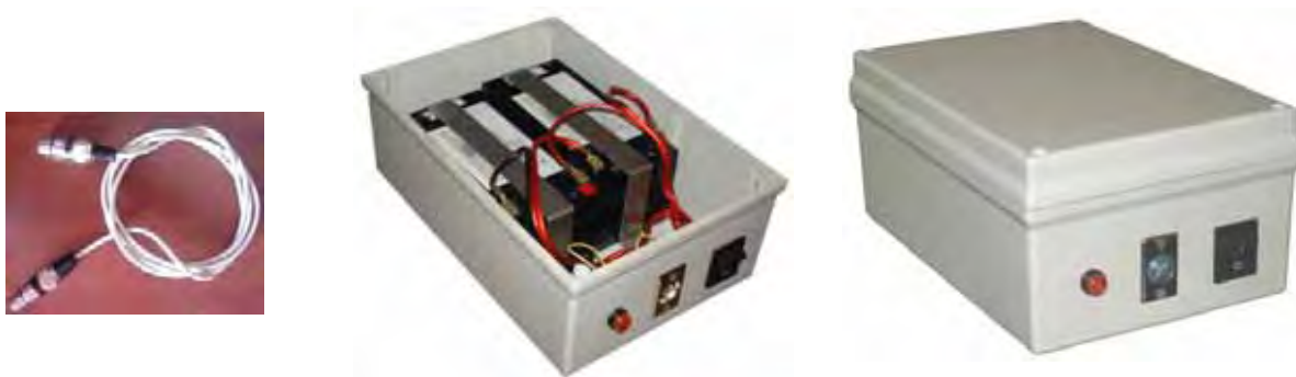
Figura 15. Cabo de alimentação (esquerda) e vistas em perspectiva do sistema de alimentação (centro e direita).
