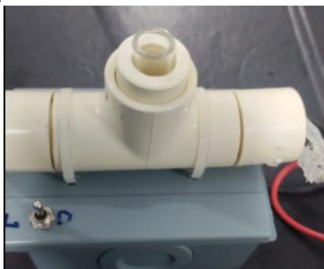
13. Na parte superior do Tê de 90°, inserir o tubo de ensaio.
