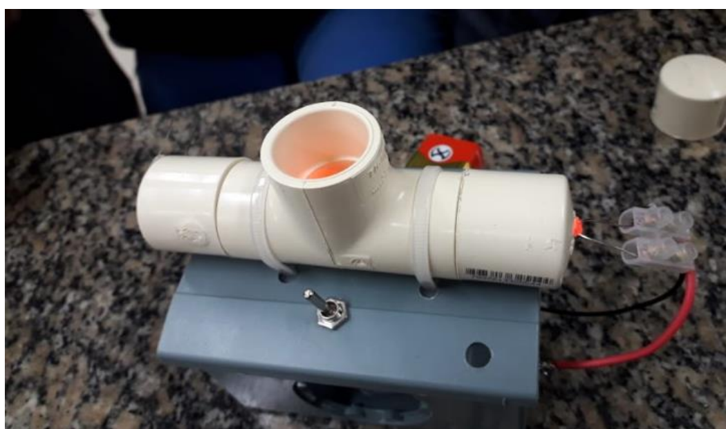
Figura 9. Fotômetro construído com Led vermelha (Fonte: Autor)
