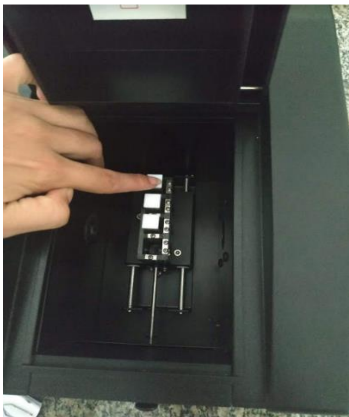
Figura 14. Aula teórica: Vista interna do espectrofotômetro (Fonte: Autor)
