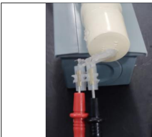
13. Na parte superior do Tê de 90°, inserir o tubo de ensaio.
