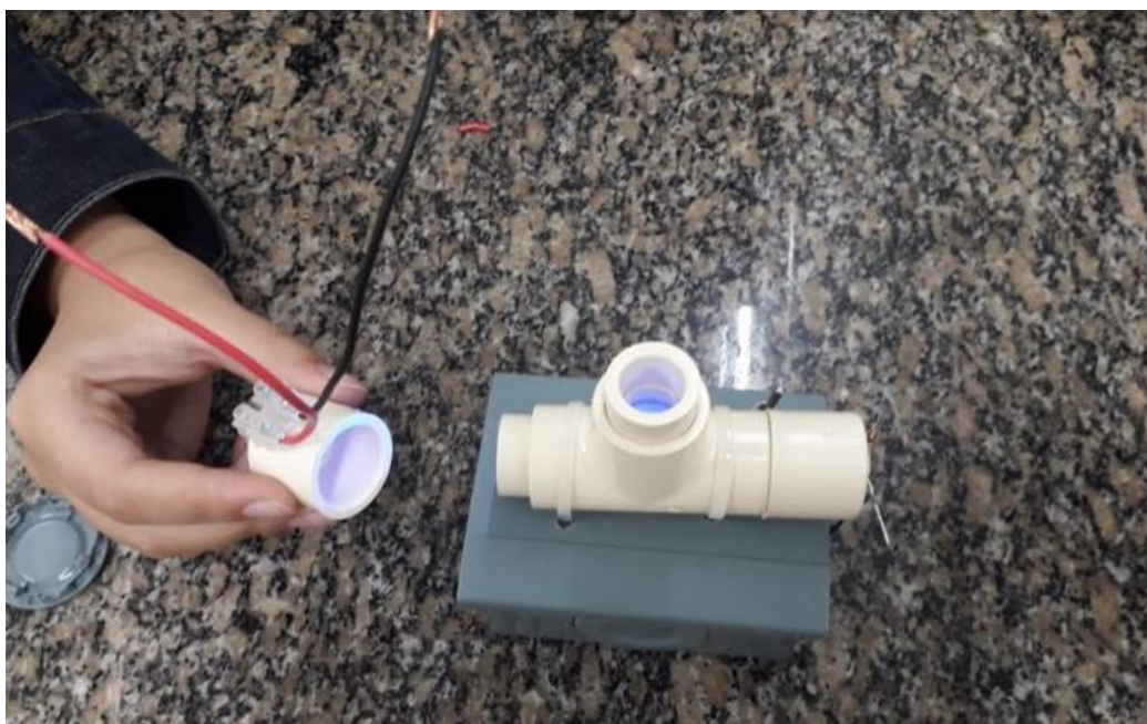
Figura 8. Fotômetro construído com Led azul (Fonte: Autor)
