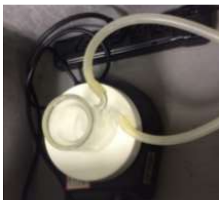
Figura 3. Fotos do reator de vidro usado nas reações de fotocatalise. Imagens obtidas pela autora.
