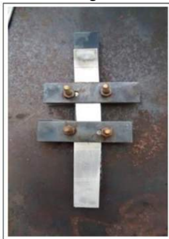
Figura 24 - Dispositivo utilizado para fixação da liga AA 2024 e PEI/Fibra de vidro durante a soldagem.
