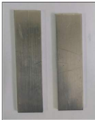
Figura 19 – Amostas da liga AA 2024 utilizados na soldagem.
