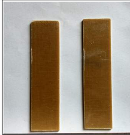
Figura 18 — Amostas de PEI/fibra de vidro utilizados na soldagem.
