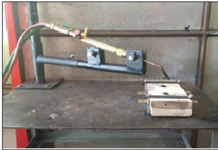
Figura 11 - Dispositivo desenvolvido para soldagem
