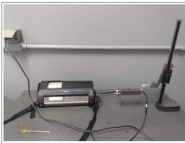
Figura 35 - Rugosímetro utilizado para medição da rugosidade.
