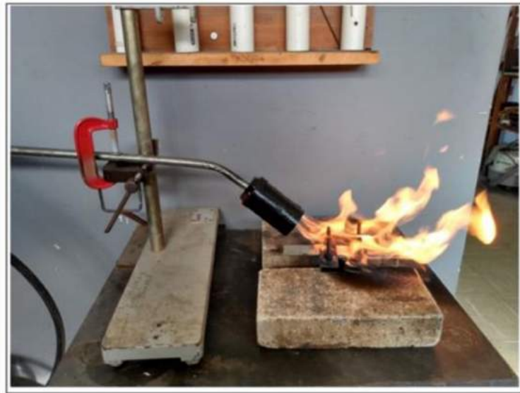
Figura 22 - Processo de soldagem por oxi-combustível.
