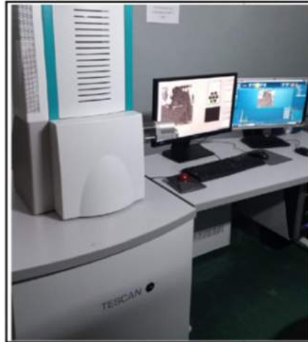
Figura 33 - Microscopia Eletrônica de Varredura – (MEV) utilizado.
