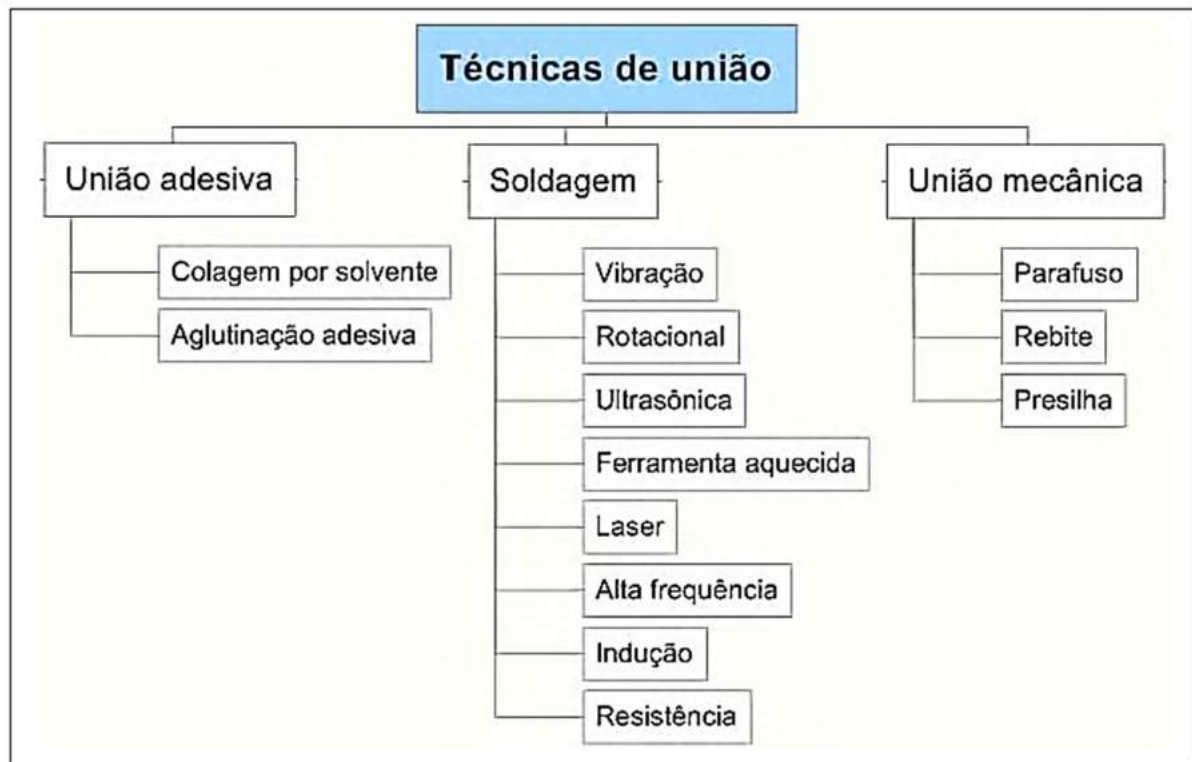
Figura 6 – Tipos de uniões para compósitos.
