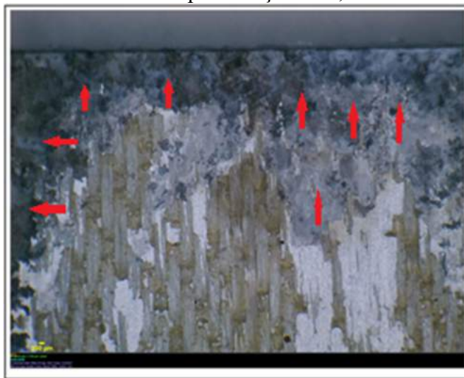
Figura 57 - Região rompida da liga AA 2024 após imersão em água do mar sintética, a 30 °C. Aproximação de 6,5 x
