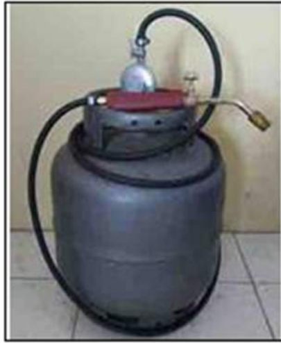
Figura 12 - Equipamento de soldagem (gás GLP) utilizado para a junção metal-compósito.
