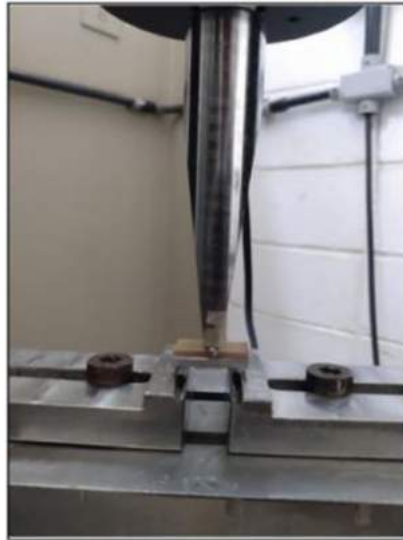
Figura 30 - Ferramenta utilizada para o ensaio de ILSS.
