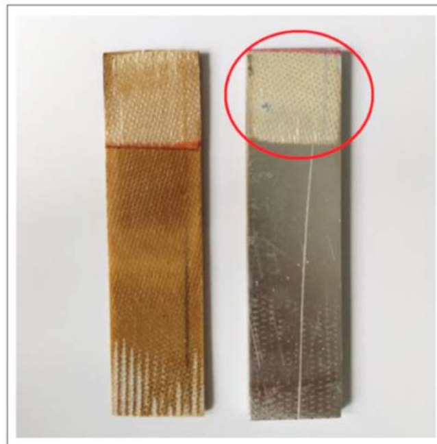
Figura 46 - Amostra de PEI fibra de Vidro e da liga AA 2024 rompida.
