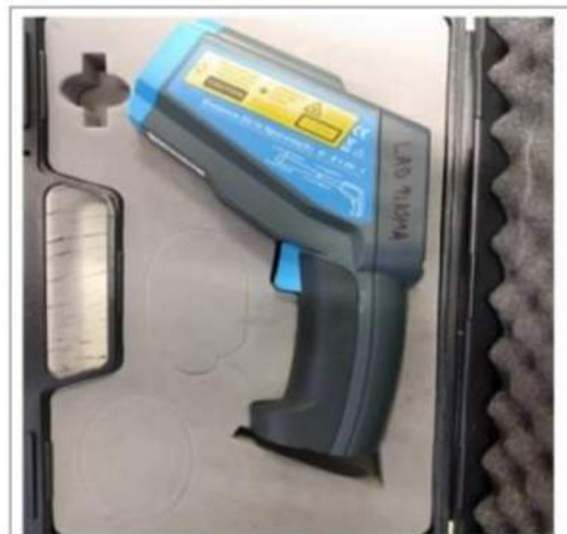
Figura 23 - Pirômetro utilizado para a medição da temperatura.
