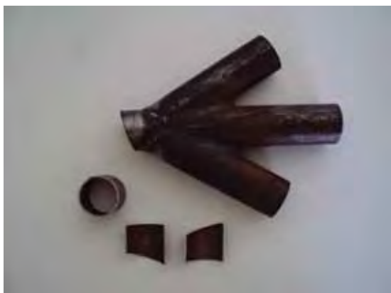
Figura 3: Corte 1 da amostra para embutimento
