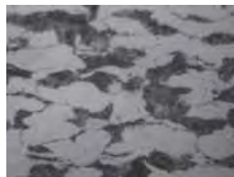
Figura 24: Microestrutura 1 para o aço em corte superficial usado em condições reais, com ampliação de 1000 vezes
