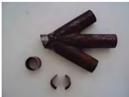
Figura 4: Corte 2 da amostra para embutimento
