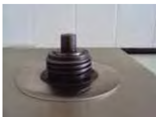
Figura 10: Encaixe da peça solta de metal para o embutimento com bom acabamento para o equipamento
