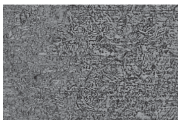
Figura 36: Ataque Nital na Solda do Aço Cru com em corte transversal aumento de 200 vezes
