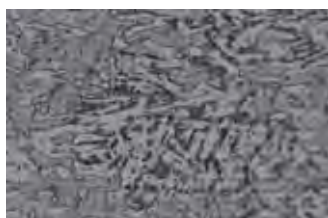
Figura 38: Ataque Nital na Solda do Aço cru em corte transversal com aumento de 500 vezes
