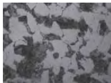
Figura 19: Microestrutura 1 para o aço normalizado em corte transversal , com ampliação de 1000 vezes (Ataque Nital)
