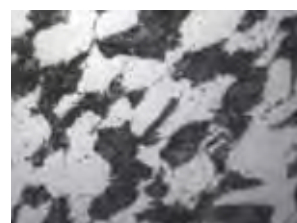
Figura 49: Microestrutura para o aço em corte superficial normalizado, com ampliação de 1000 vezes
