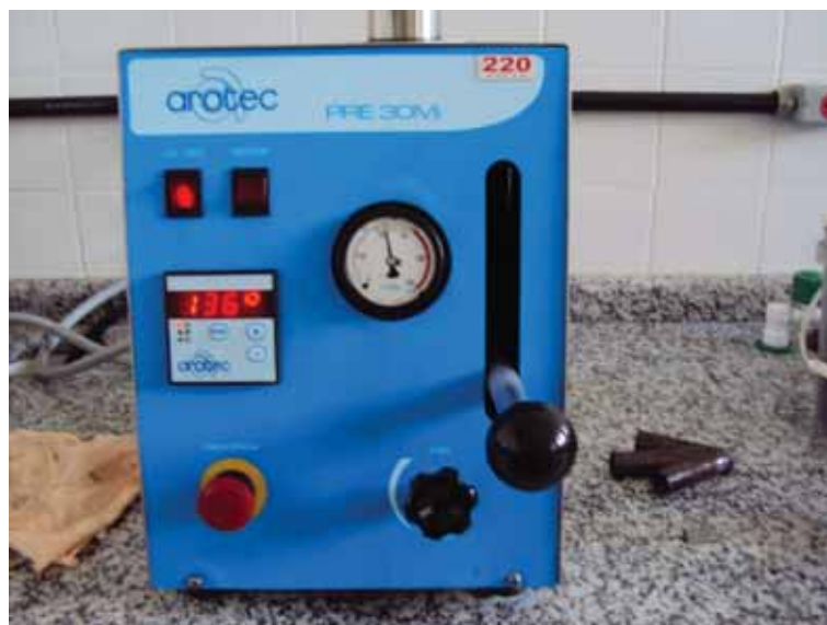
Figura 12: Equipamento para Embutimento Arotec (modelo PRE 30M)
