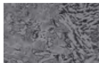
Figura 37: Ataque Nital na Solda do Aço Cru em corte transversal com aumento de 1000 vezes
