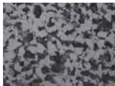
Figura 18: Microestrutura 2 para o aço normalizado em corte transversal , com ampliação de 500 vezes (Ataque Nital)
