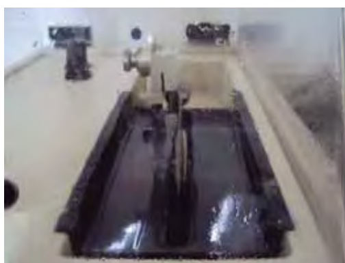
Figura 5: Isomet 1000 durante o corte da amostra
