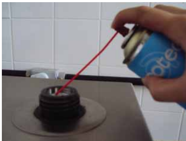
Figura 8: Lubrificação do equipamento de embutimento
