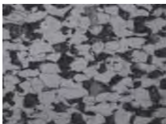
Figura 22: Microestrutura 1 para o aço em corte superficial usado em condições reais, com ampliação de 500 vezes
