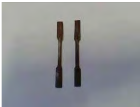
Figura 7: Corpos de prova para ensaio de tração
