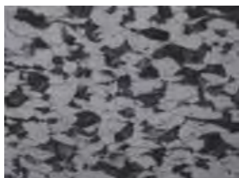
Figura 22: Microestrutura 1 para o aço em corte superficial usado em condições reais, com ampliação de 500 vezes
