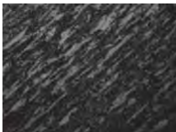
Figura 34: Microestrutura 2 para o aço em corte superficial para estudos, com ampliação de 500 vezes
