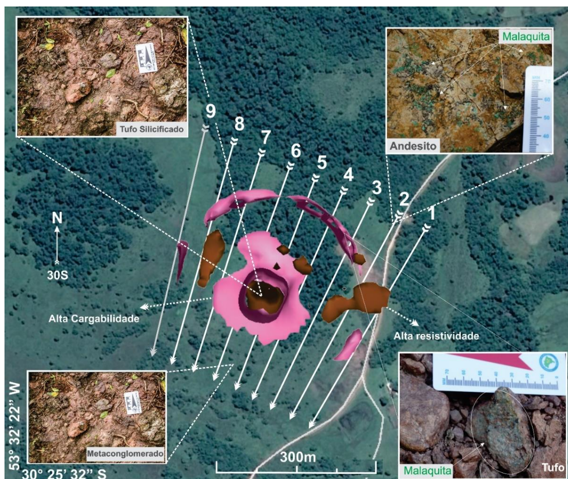
Figura 9.5 Mapa da área de estudos com disposição dos litotipos aflorantes e modelo integrado de isosuperfície 3D ressaltando zonas de alta cargabilidade em rosa e alta resistividade em marrom. Destaque para halo radial periférico de alta cargabilidade, possivelmente relacionado à zona de fraturas e estruturação do relevo.
