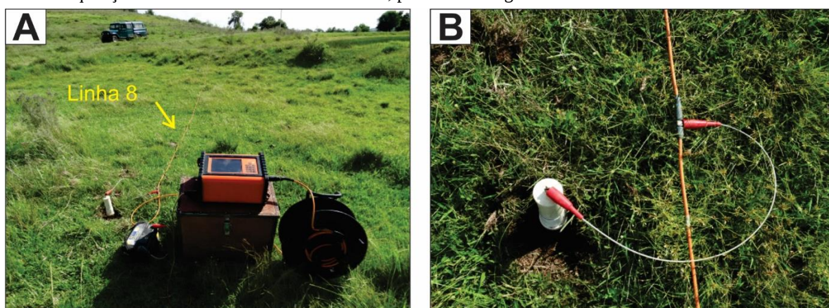
Figura 7.4 (A) Vista geral do modo de aquisição dos dados geoeletricos (eletrodo, cabo de aquisição, bateria e equipamento Terrameter LS). Esquema montado para aquisição da Linha 8. (B) Detalhe para a conexão entre o cabo de aquisição de dados e o eletrodo de cerâmica, por meio das agarras condutoras de eletricidade.
