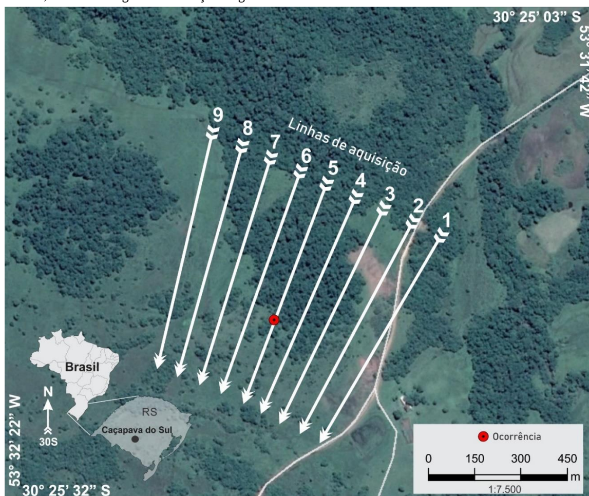
Figura 7.2 Mapa de localização da área de estudo, com disposição e orientação das linhas de aquisição geofísicas, orientadas segundo declinação magnética da bússola em 20°.
