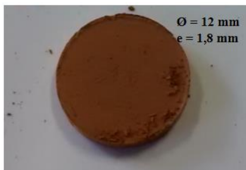
Figura 30 – Amostra após a prensagem com 8% água.
