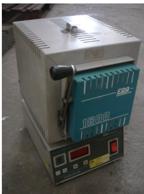
Figura 13 – Equipamento utilizada para calcinar os pós.
