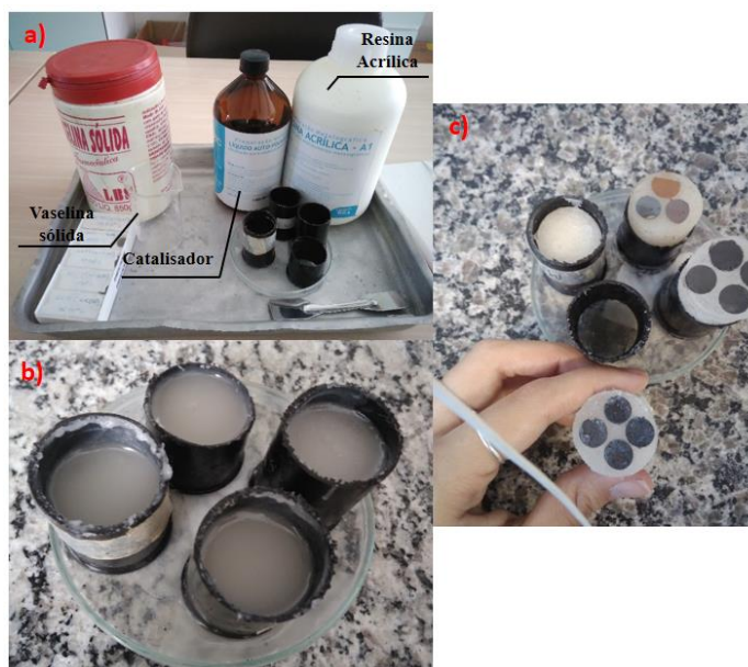
Figura 23 – a) Reagentes utilizados no embutimento à frio; b) Resina + catalisador ainda líquidos no suporte de PVC; c) Aparência final do embutimento, com a mistura já sólida.
