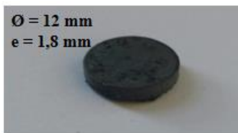
Figura 38 – Pastilha X = 0,00 sinterizada a 1100 °C.
