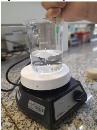
Figura 16 - Imobilização em forma esférica da enzima com alginato de cálcio.
