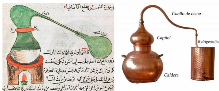
Figura 2 - Representação do alambique árabe e o atual feito de cobre
