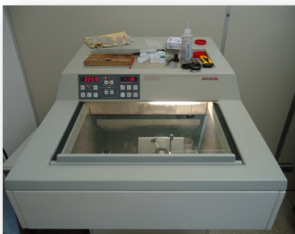
FIGURA 5 - Aparelho Micron HM 505 E Cryostat Microtome Freezing da eBay® - EUA. Utilizado para o processamento dos músculos.
