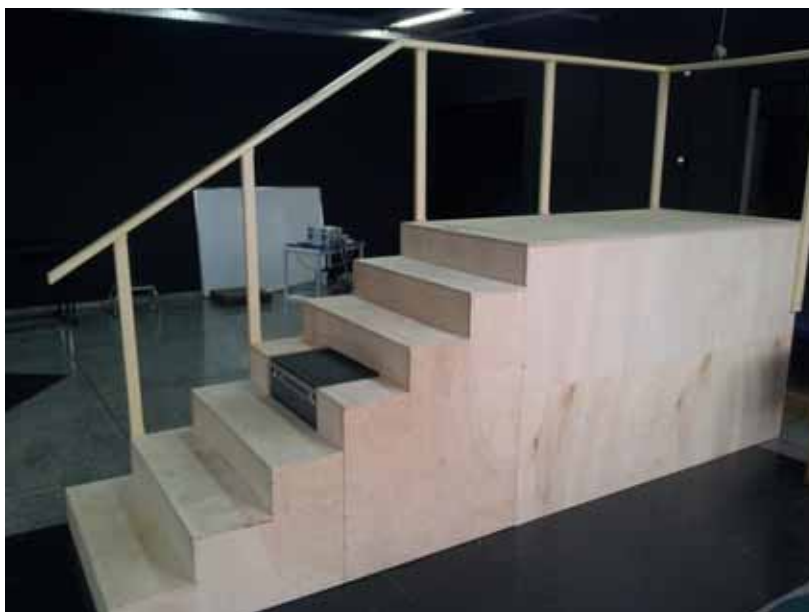
Figura 3 - Escada sem o tapete emborrachado com a plataforma de força embutida no quarto degrau.
