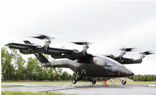
Figura 7 – Modelo de eVTOL Vectored Thrust tilt-rotor VA-1X nas duas configurações de posição de rotores
