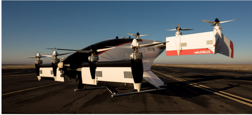
Figura 6 – Modelo de eVTOL Vectored Thrust tilt-wing Airbus A3 Vahana
