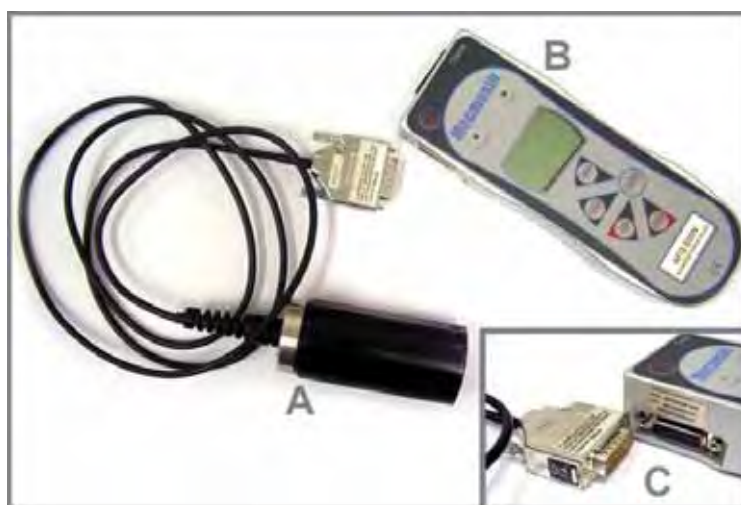
Figura 5: Equipamentos de Medição - Torquímetro e AFG
