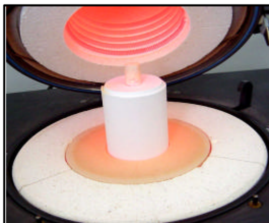
Figura 4.3.1.2 Êmbolo de alumina posicionado após colocação do lingote no forno EP-500
