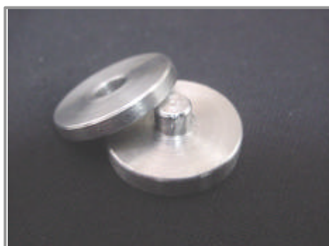
Figura 4.2.2 Matriz utilizada para confecção dos espécimes de resistência à tração diametral.
