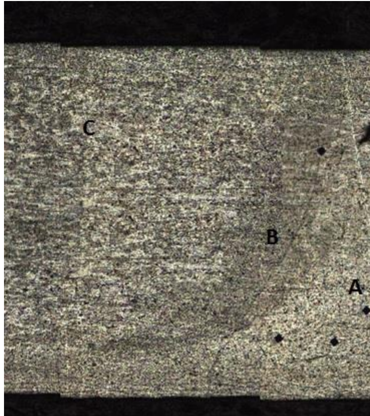
Figura 27 – Região de transição da solda a 1250 RPM (200x)
