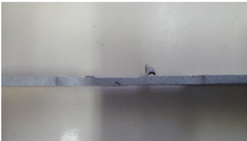
Figura 14- Falha Presente no Corpo de Prova da Solda 1150 RPM
