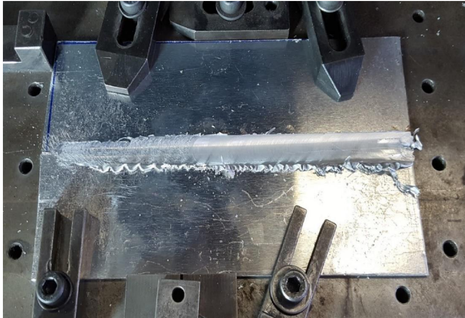
Figura 2-Dispositivo de Fixação junto a uma junta soldada.
