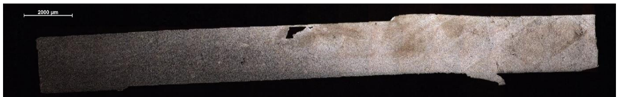
Figura 26- Corte transversal amostra a 1250 RPM com dimensões de 24x2,4mm (50x)
