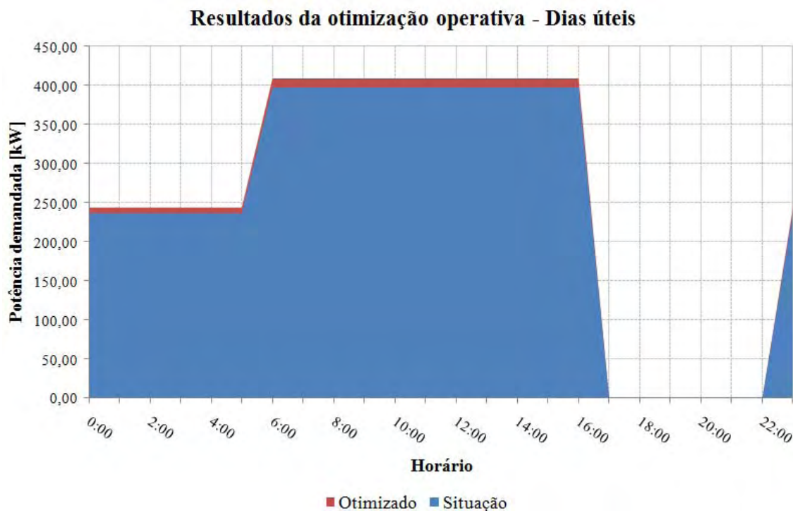
Figura 68 – Perfil horário de cargas elétricas na captação de Itajubá – dias úteis
