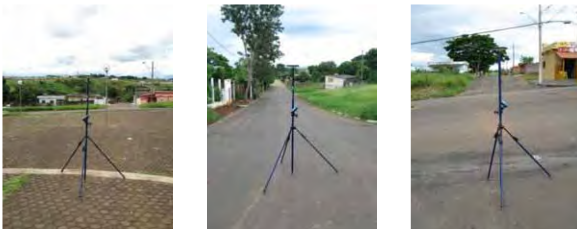
Figura 104 – Coleta de dados com GPS topográfico
