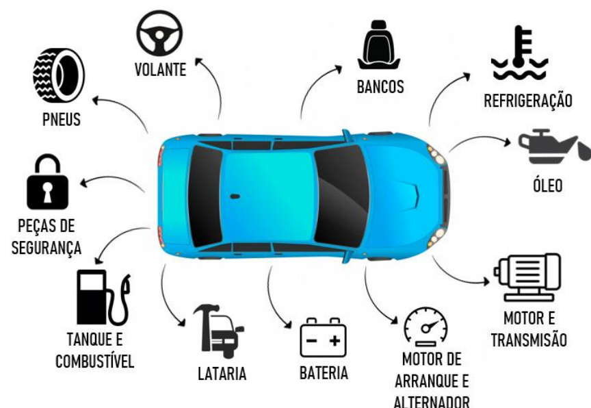
Figura 5 – Componentes de um veículo que podem ser reciclados ou reutilizados.
