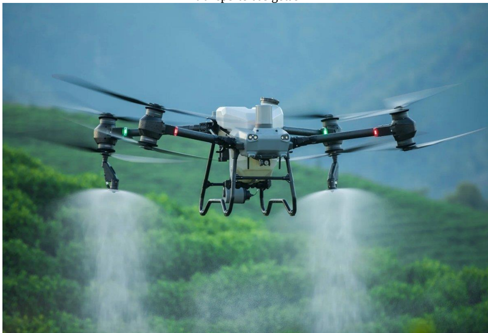
Figura 2.9 - Aplicação de disco rotativo para atomização das gotas em drone, com assistência das pás para transporte das gotas
