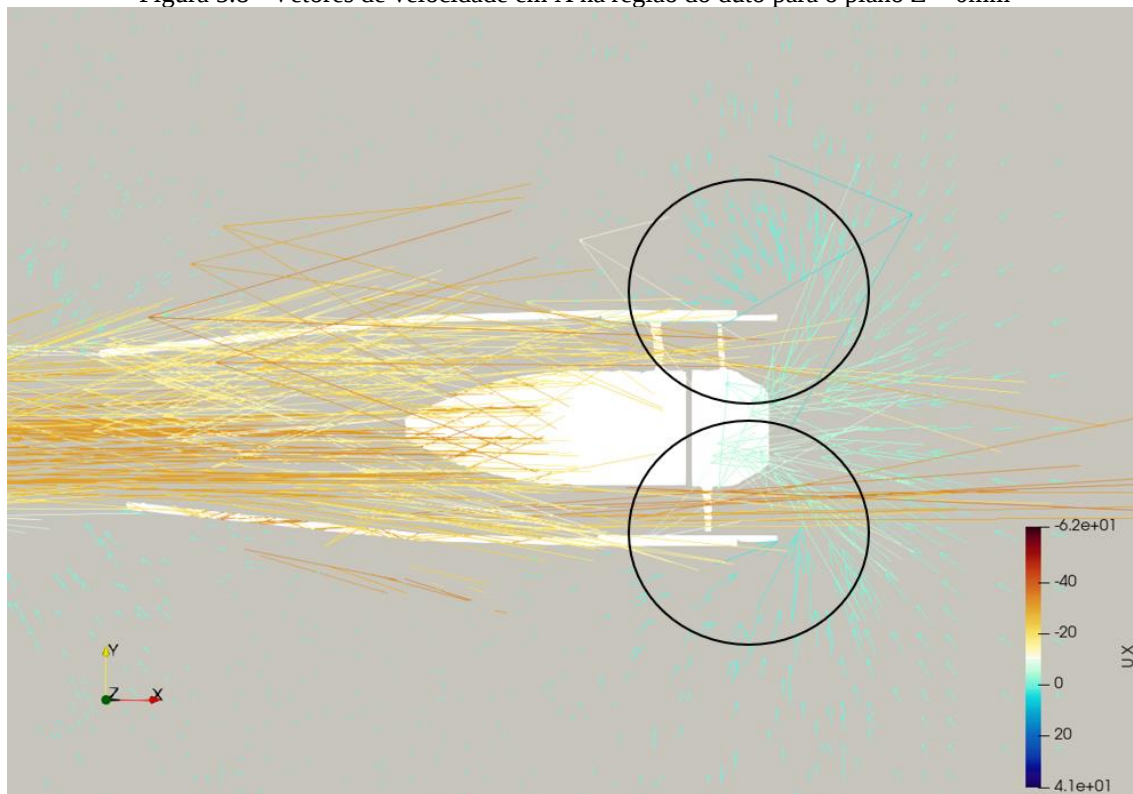
Figura 5.8 - Vetores de velocidade em X na região do duto para o plano Z = 0mm
