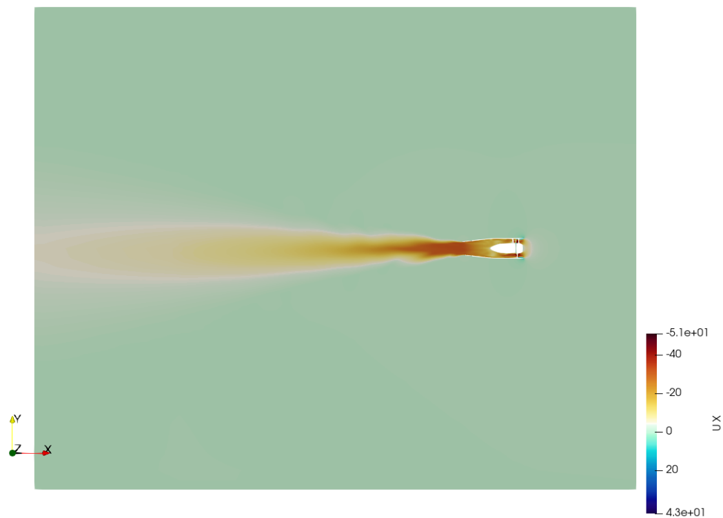
Figura 5.1 - Campo de velocidades em X para todo o domínio no plano Z = 0 mm
