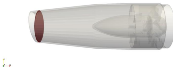
Figura 4.11 - Indicação da superfície para medição da vazão
