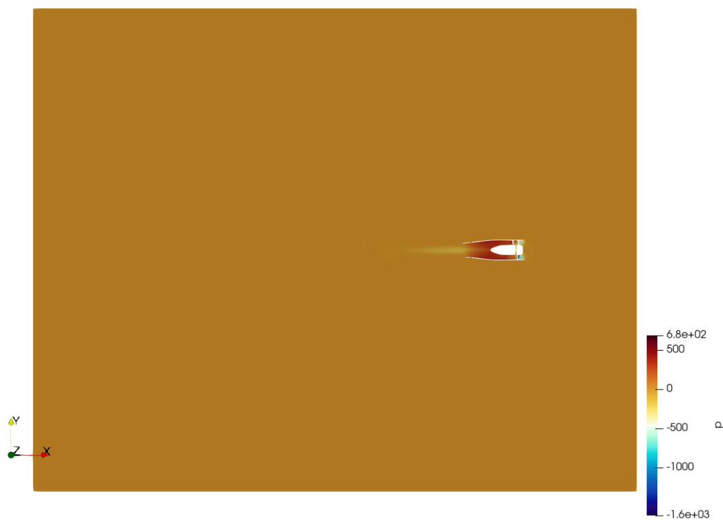
Figura 5.3 - Campo de pressão para todo o domínio no plano Z = 0 mm
