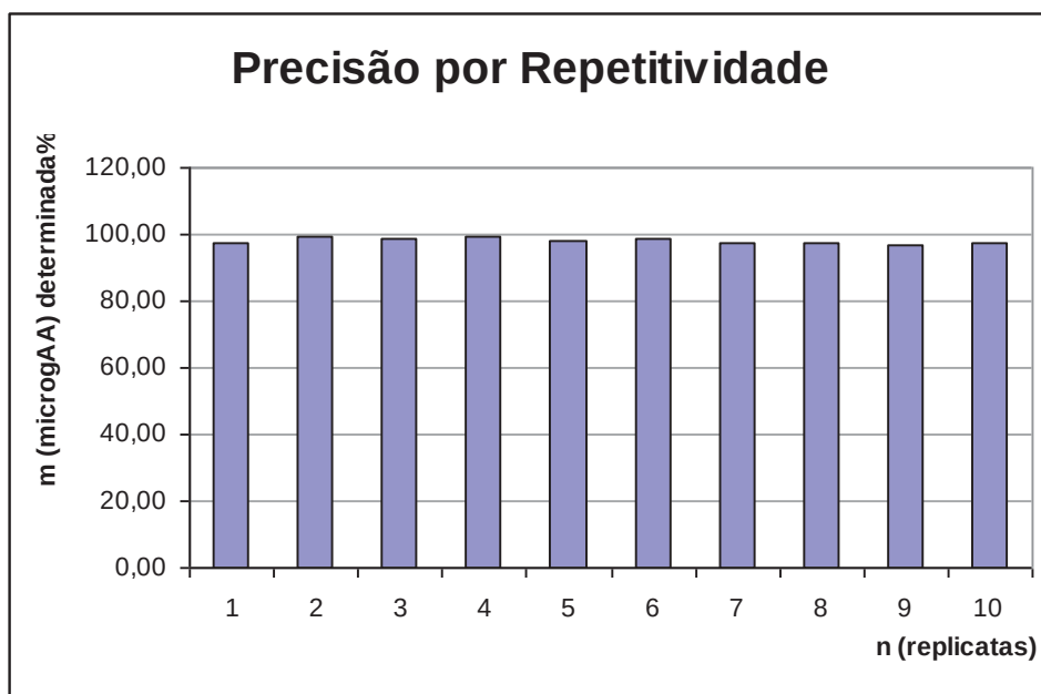
Figura 5.4 - Determinação da precisão por repetitividade , \pm s , n=10 para a mAA de 29,573 \mu\text{g} para método espectrofotométrico usando DCFI; \pm sr=0,2613 \mu\text{g}
