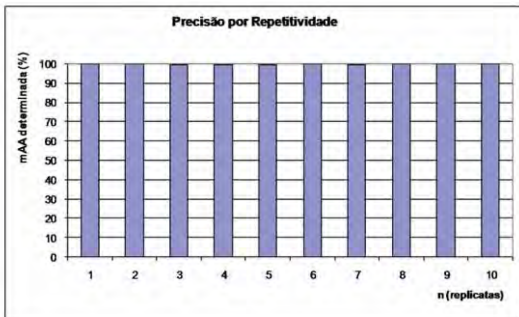
Figura 4.4 - Determinação da precisão por repetitividade , \pm s , n=10 para a mAA de 7,012 mg e titulação com DCFI; \pm sr=0,0157mg
