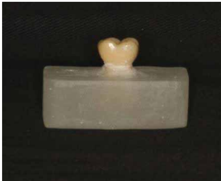
FIGURA 3 - Bloco de resina acrílica com dente artificial inserido
