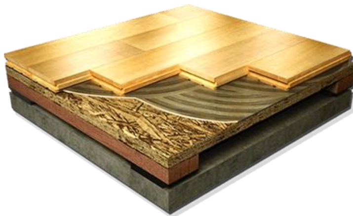
Figura 65 – Detalhamento piso de madeira flutuante.
