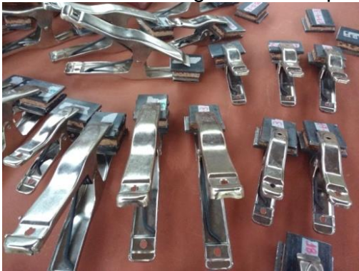
(a) Fixação dos suportes metálicos com Super Bonder
