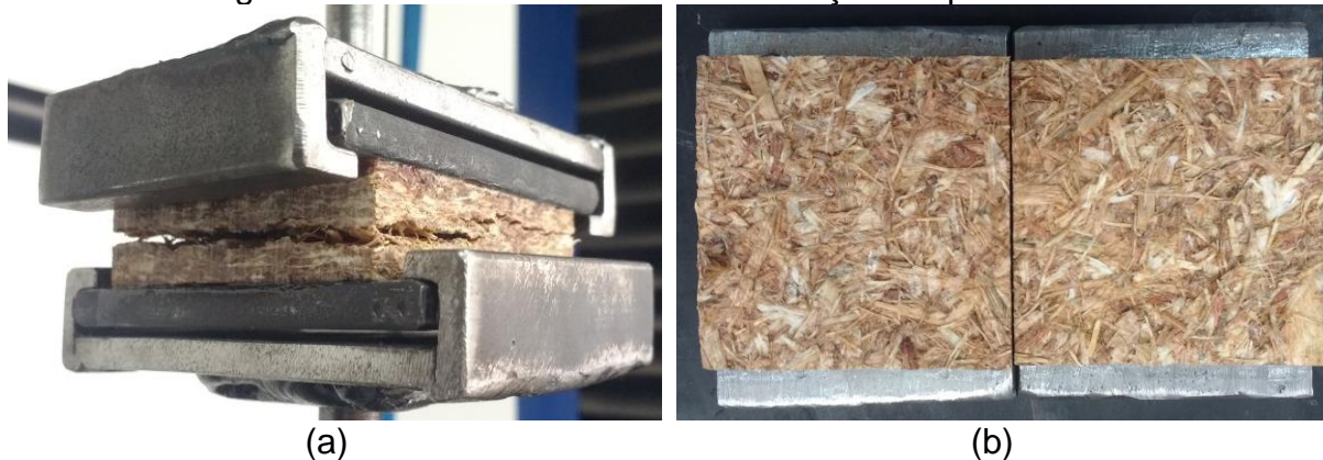
Figura 32 - Ensaio de Resistência à Tração Perpendicular
