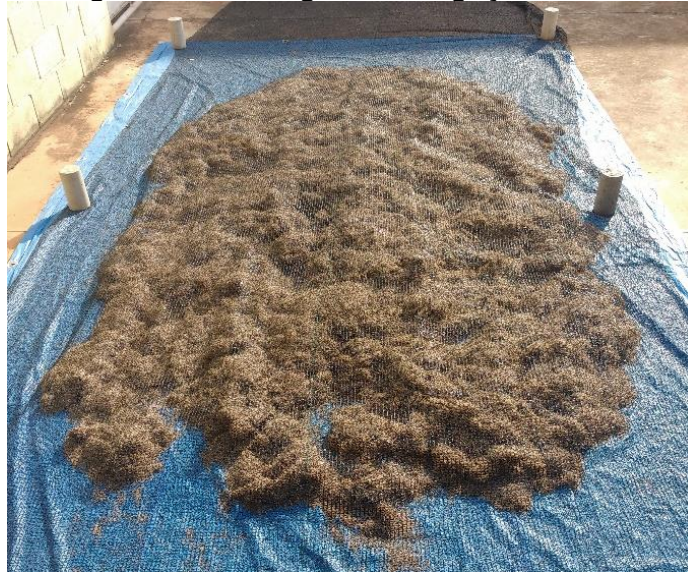
Figura 15 - Secagem do bagaço de cana
