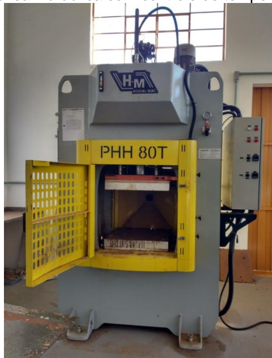
Figura 21 - Prensa hidráulica com controle de temperatura e pressão
