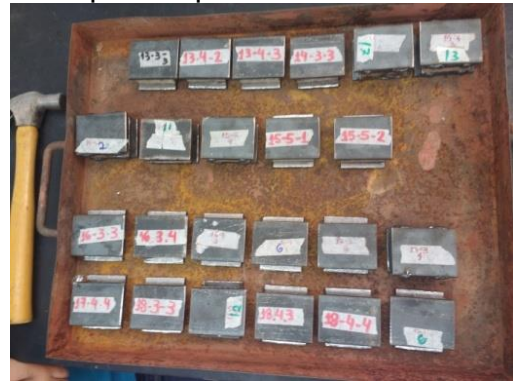
(b) Corpos de prova preparados para o ensaio de TP
