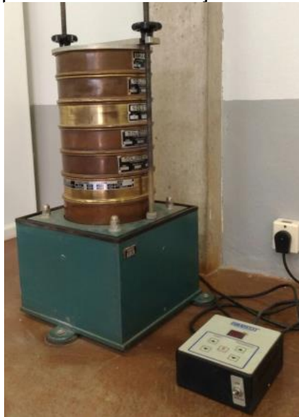
Figura 18 - Agitador de peneiras. Determinação da composição granulométrica
