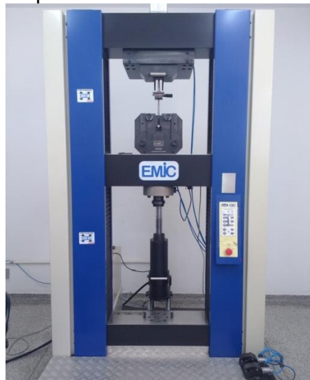
Figura 29 - Máquina universal realizando o ensaio de TP
