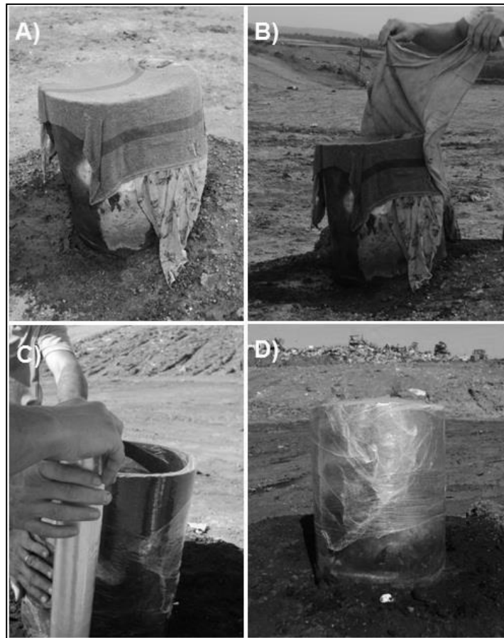
Figura 9. Procedimento de fechamento do dreno de biogás para efetuar a aquisição de dados (Antonio, 2012)
