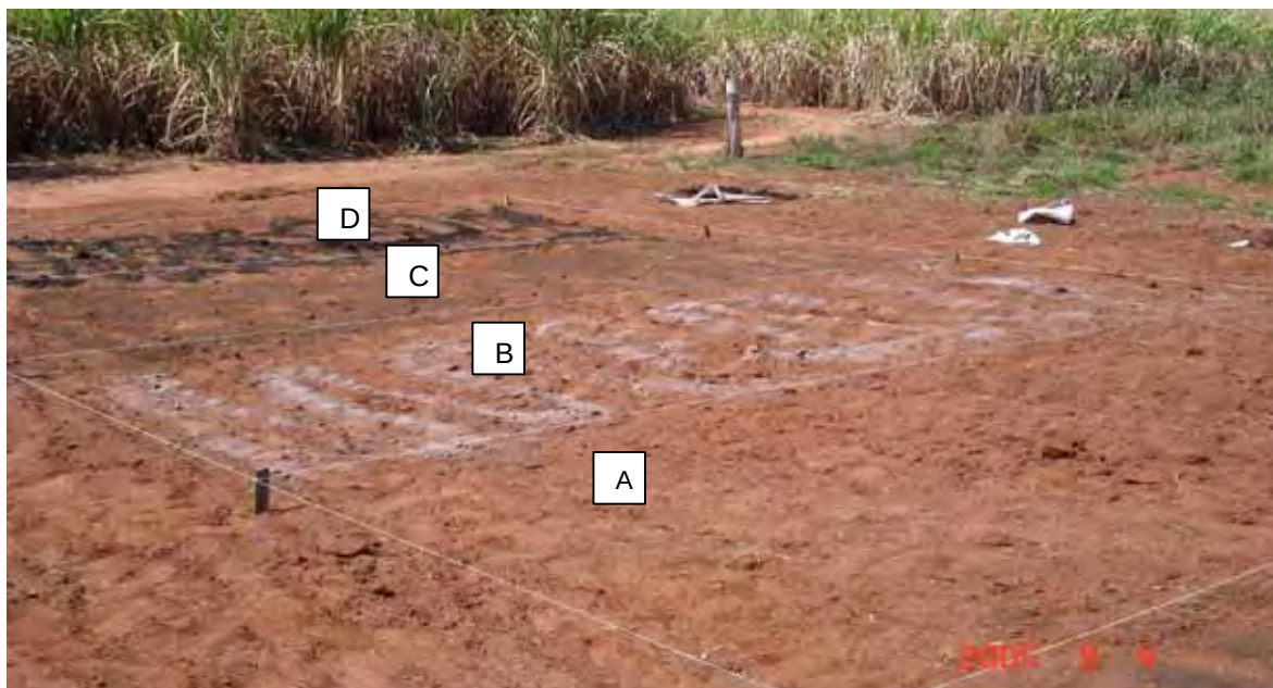
Figura 16: Distribuição dos tratamentos para posterior incubação. A= solo, B= Boletim 100, C= composto de lixo de Araras-SP (30 Mg ha -1 ), e D= Composto Ecosolo (30 Mg ha -1 ).
