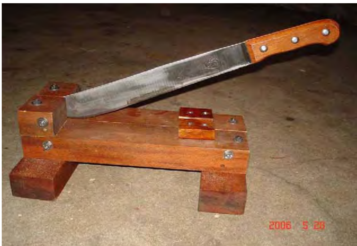
Figura 25: Instrumento montado (guilhotina) e utilizado para cortar as folhas de Cymbopogon citratus .
