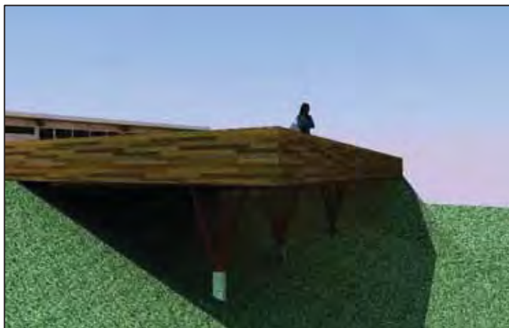
Figura 75: Detalhe da estrutura de aço patinado e concreto do deck
