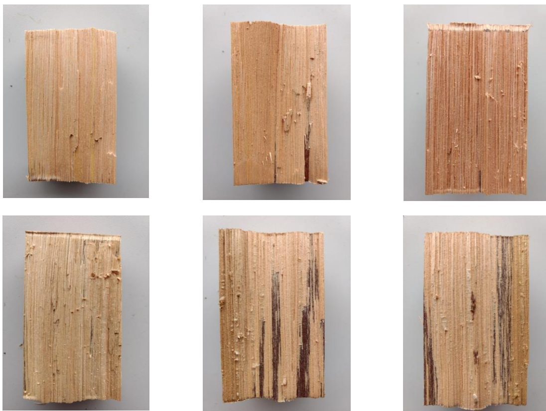
Figura 35 - Exemplos de modo de ruptura da combinação ERS.
