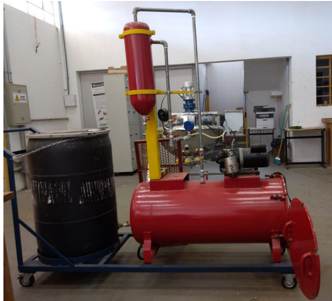
Figura 25 - Equipamentos (autoclave) para ensaio de delaminação na linha de cola.
