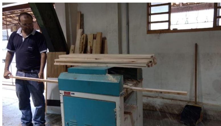
Figura 20 - Aplainamento das lamelas.
