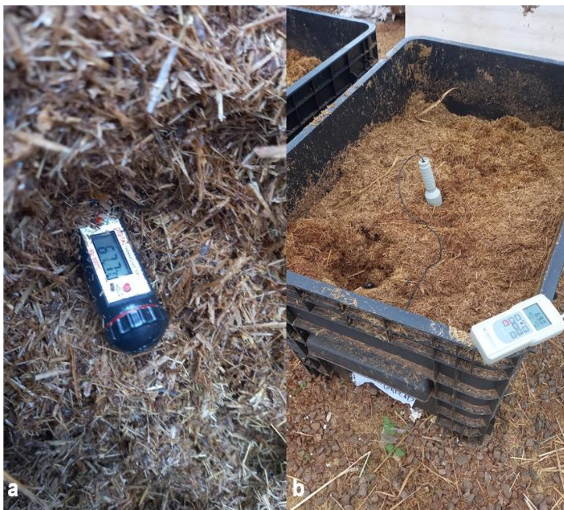
Figura 13. Afeições realizadas diariamente nos substratos durante a fermentação; a: afeição da temperatura com a utilização do termômetro; b: medidor de umidade durante o processo.
