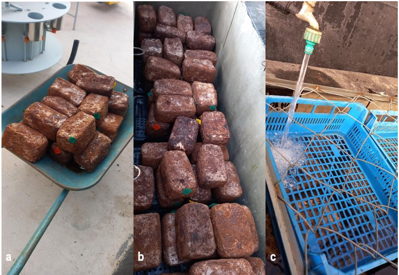
Figura 11. Processo de choque através da submersão realizado no tanque; a: transporte dos blocos para indução; b: adição dos blocos no tanque; c: blocos já posicionados aguardando completa submersão para iniciar a contagem regressiva de 6 horas.
