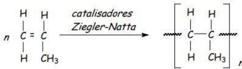
Figura 2 - Polimerização do propeno para obtenção do polipropileno.
