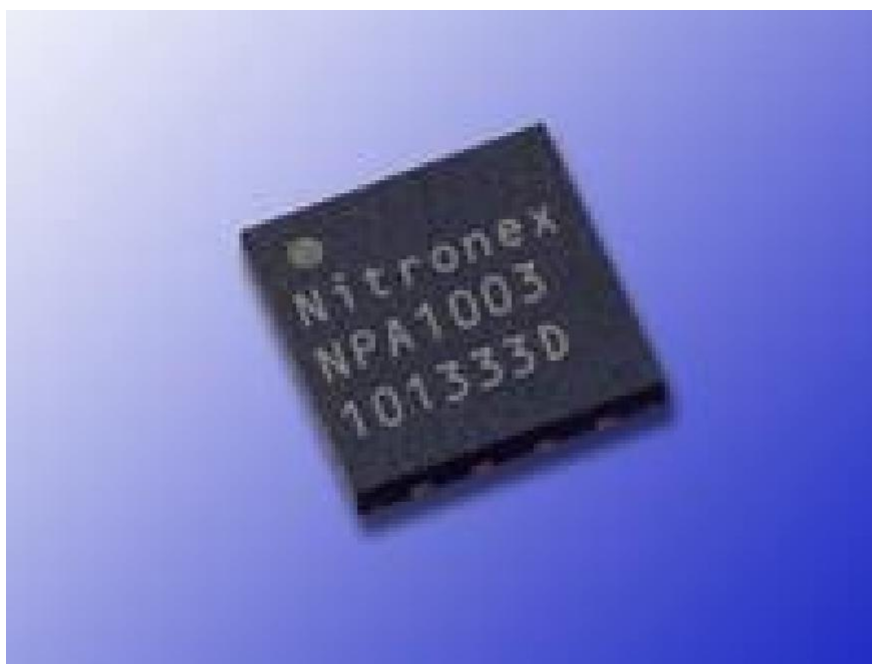
Figura 1 – Amplificador de banda larga NPA1003 GaN. Potência de saída 5W. Resposta em frequência de 20 até 1500MHz. Dimensões 4 mm x 4 mm.
