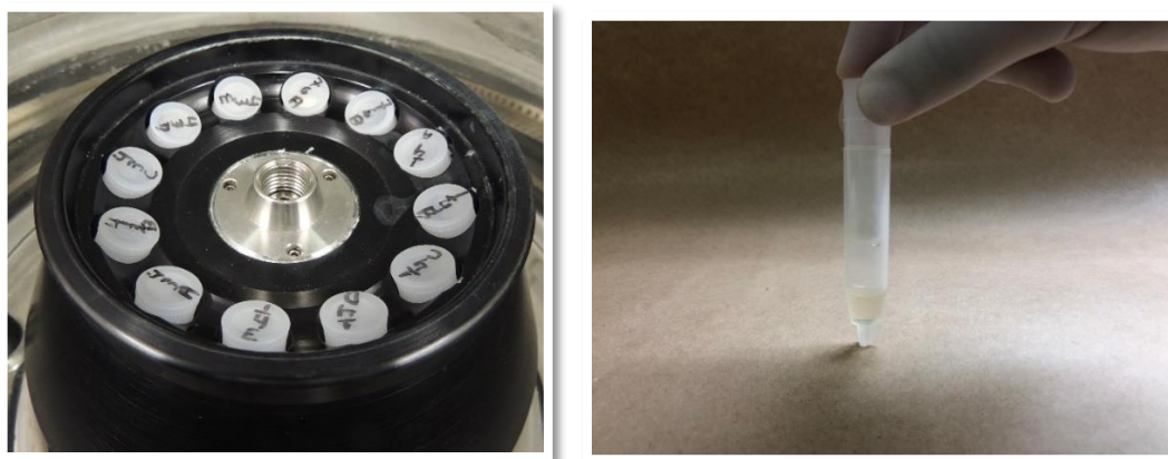
Figura 8. Centrifugação das amostras de saliva ( 5500 \times g , 10 minutos, 4^{\circ}\text{C} ) para posterior transferência para microtubos de centrifugação.
