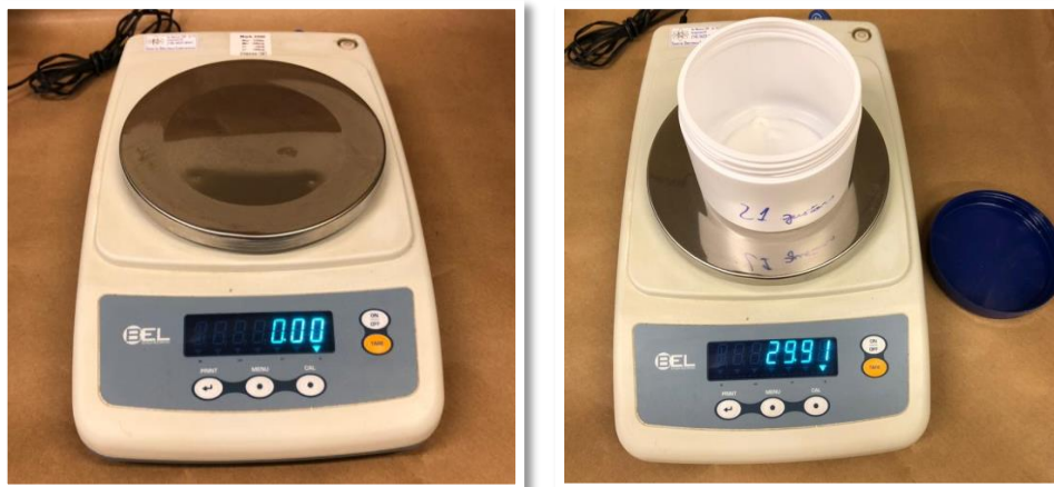
Figura 12. Pesagem dos recipientes coletores antes das coletas.
