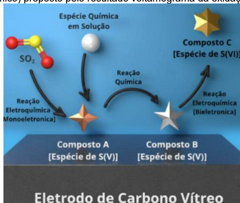
Figura 11 – Esquema visual do mecanismo EQE (Eletroquímico – Químico – Eletroquímico) proposto pelo resultado voltamograma da oxidação de \text{SO}_2 .
