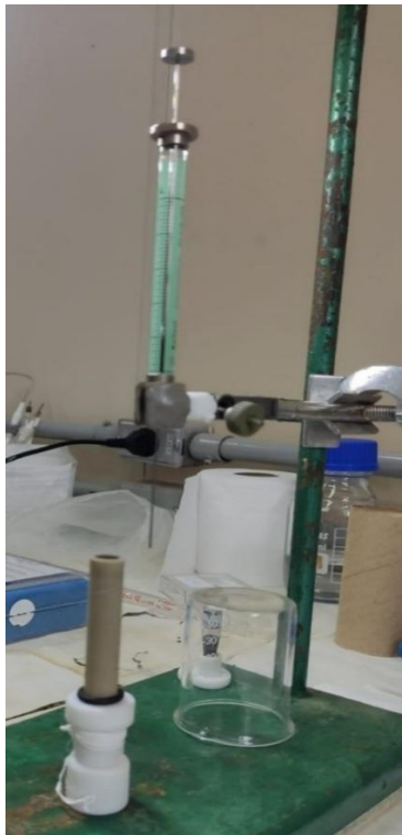
Figura 6 – Processo de deposição das suspensões de GO e rGO sob o eletrodo de trabalho utilizando uma microseringa.
