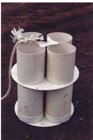
Figura 7 – Câmara de sedimentação (visão lateral).
