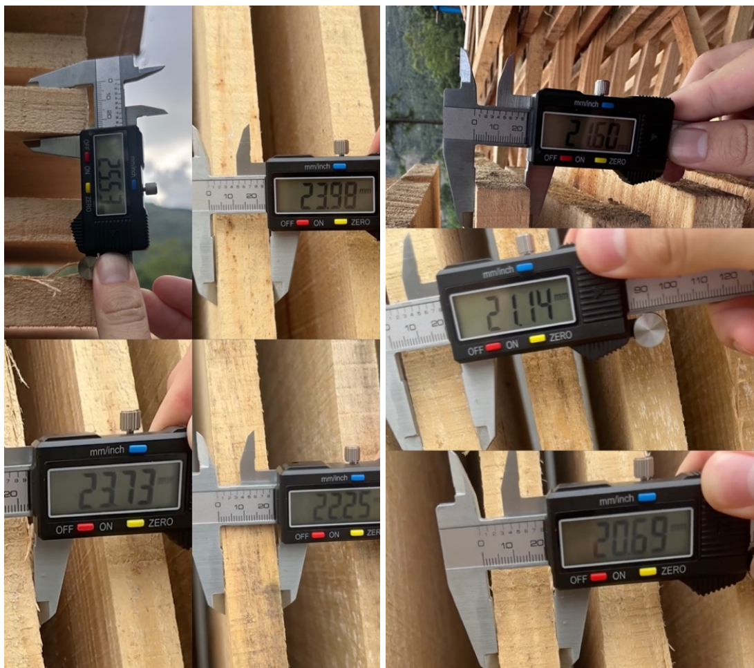
Figura 18 - Medição Espessura Molhada e Seca
