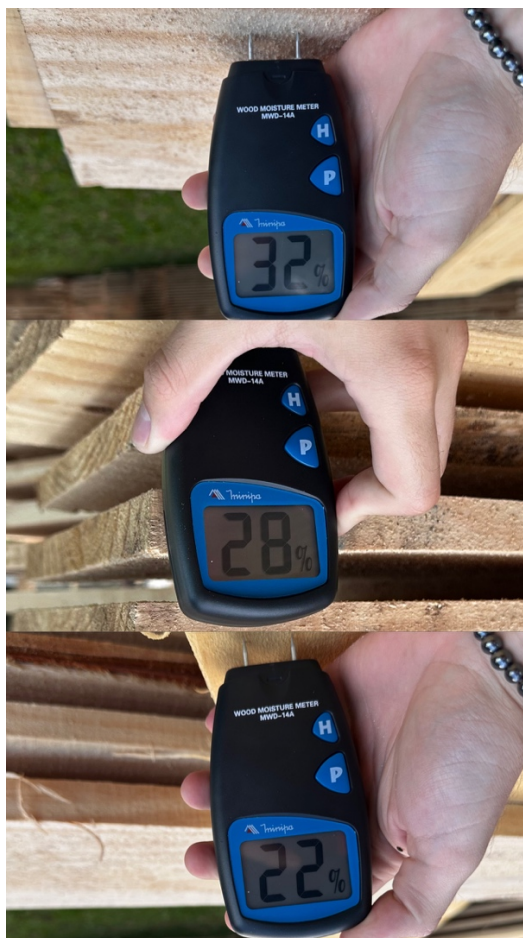
Figura 13 - Progresso da Evaporação na Madeira
