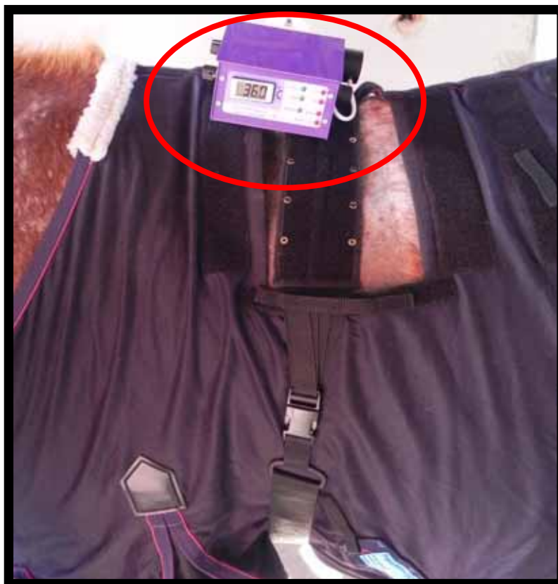
Figura 2 - Posicionamento do dispositivo do equipamento para determinar o limiar nociceptivo térmico torácico, fixado na região torácica, caudal à cernelha do equino. O dispositivo registra a temperatura em graus Celsius (°C) (Topcat Metrology Ltd)
