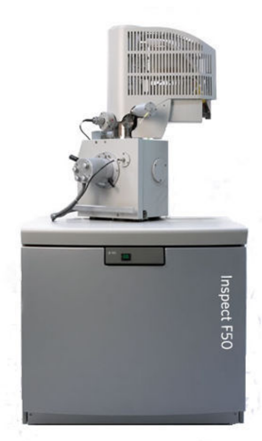
Figura 3 – Microscópio eletrônico de varredura para caracterização da superfície das amostras
