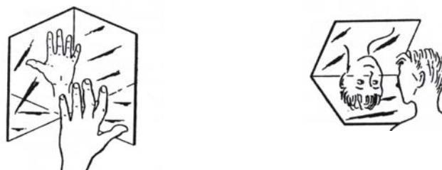
Figura 9: Reflexão em caleidoscópio com dois espelhos
