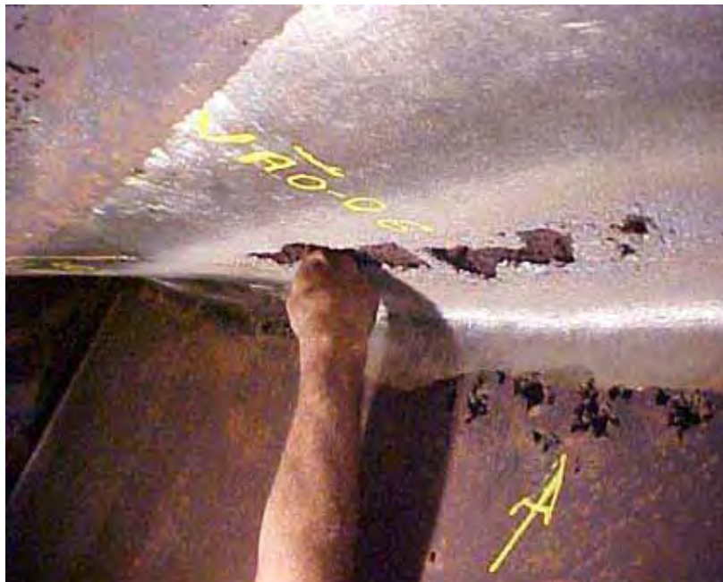
Figura 2.3: Exemplo de cavitação em perfil de rotor de turbina hidráulica. (BARELA, 2005)
