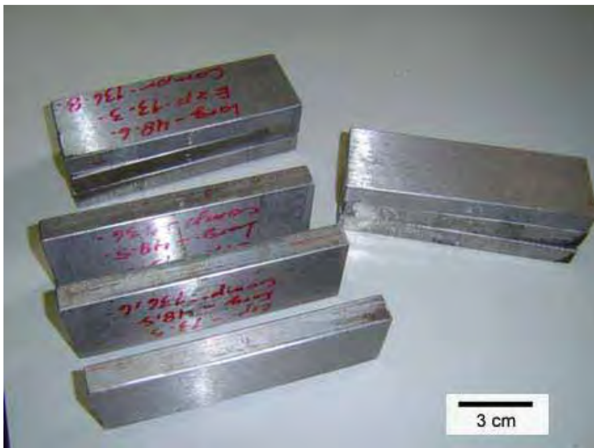
Figura 3.1 Corpos de prova obtidos de amostras de turbinas já usinados e prontos para a soldagem. (MUSARDO, 2005)
