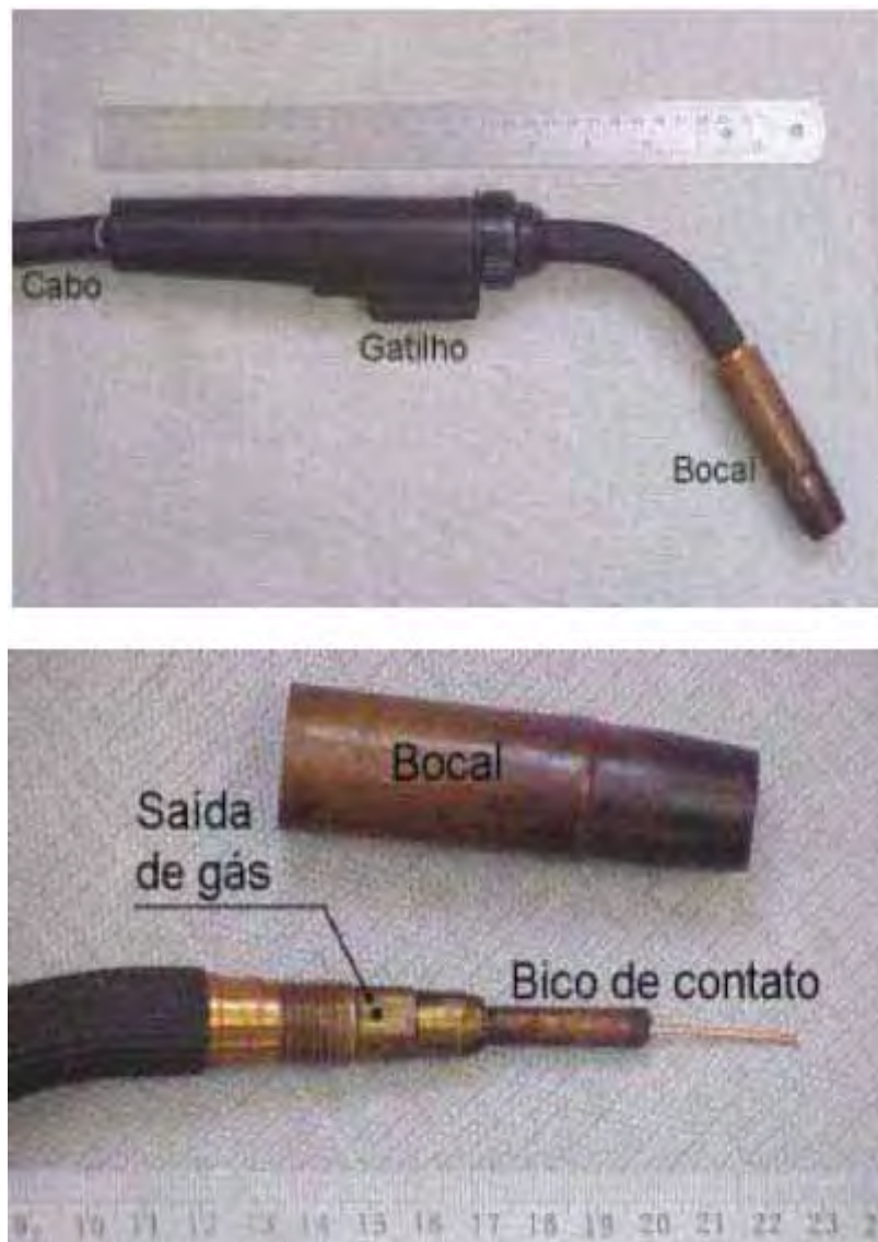
Figura 2.6: Tocha para soldagem GMAW semi-automática. ( www.infosolda.com.br )
