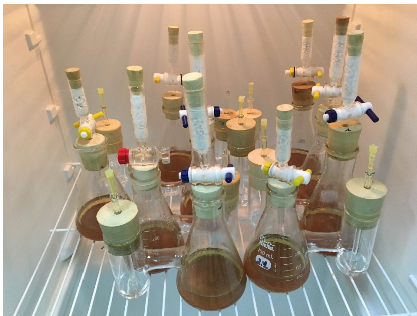
Figura 6: Ensaios respirométricos na incubadora.
