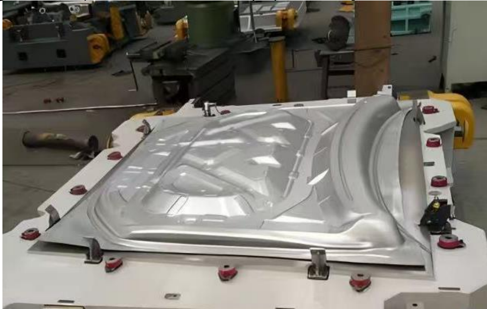
Figura 6 - Chapa conformada como capô para utilização automobilística
