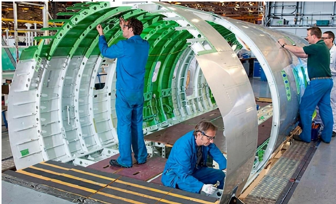
Figura 8 - Aplicação de chapas laminadas em aeronaves
